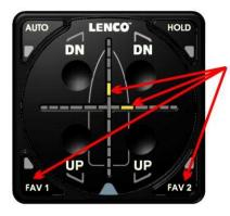
ONCE YOU HAVE FOUND THE DESIRED PITCH AND ROLL ANGLE, <u>PRESS AND HOLD</u> EITHER THE <u>"FAV 1"</u> OR THE <u>"FAV 2" BUTTONS</u>.
