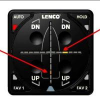
HORIZONTAL LEDS ON THE CROSSHAIR SHOW YOU THAT THE CURRENT ROLL **POSITION** OF YOUR BOAT IS ROLLED TO STARBOARD IN REFERENCE TO THE AUTO GLIDE'S HOME ROLL DEFAULT POSITION.
