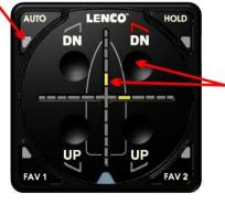
PRESS THE UP OR DN BUTTON ON THE KEY PAD TO CHANGE THE ROLL AND PITCH ANGLE OF THE BOAT.
