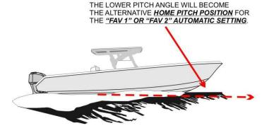
THE STARBOARD ROLL ANGLE WILL ALSO BECOME THE HOME ROLL POSITION FOR THE "FAV 1" OR "FAV 2" AUTOMATIC SETTING..
